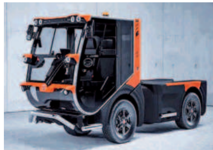
El vehículo multifuncional de Junco estrenará los motores eléctricos de cubo de Schaeffler.
